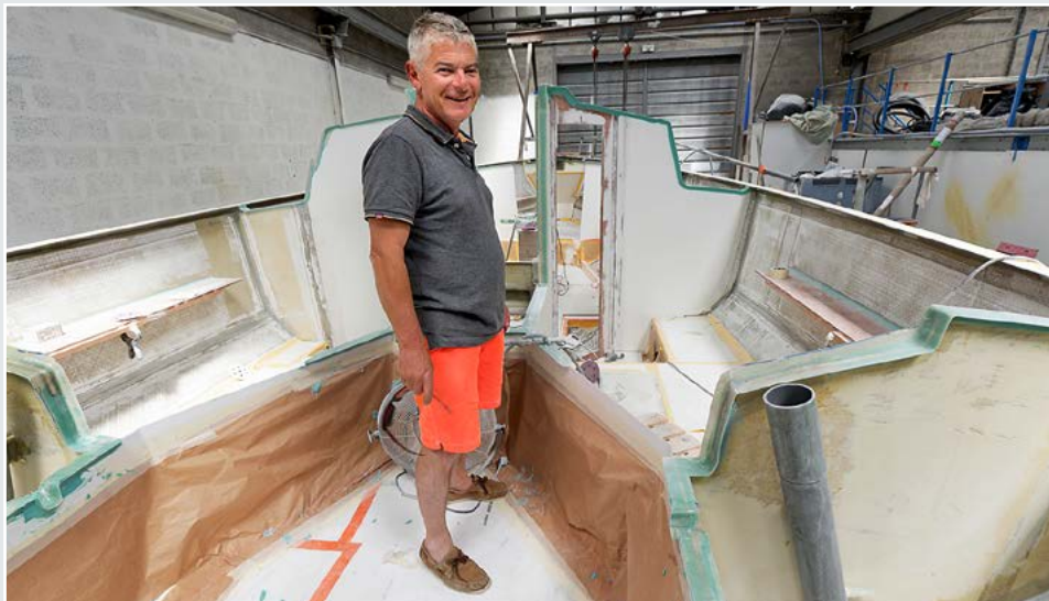
▲ Denis dans le cockpit du prochain Mojito 1088, dont le tube abritant la béquille d'échouage tribord est bien visible au premier plan. Ce Mojito sera le 64 e voilier construit par IDB Marine depuis 2005.
