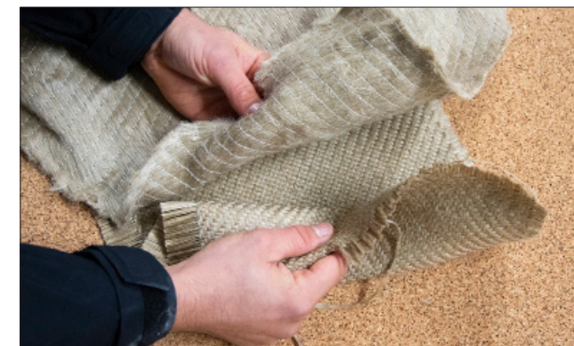
▲ Du liège et du lin tissé au cœur de ce composite aussi naturel que possible... Faut-il attendre une résine parfaite pour s'y mettre?
