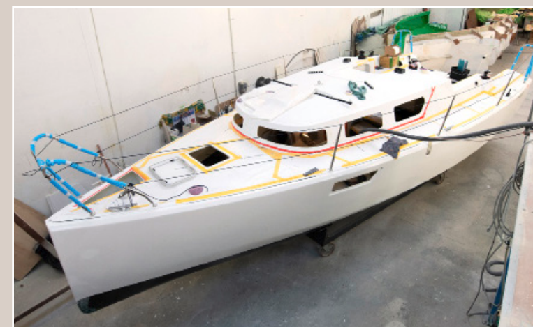
▲ Une fois le gel-coat appliqué, il est visuellement impossible de faire la différence entre Virgin et ses congénères en stratifié classique.
