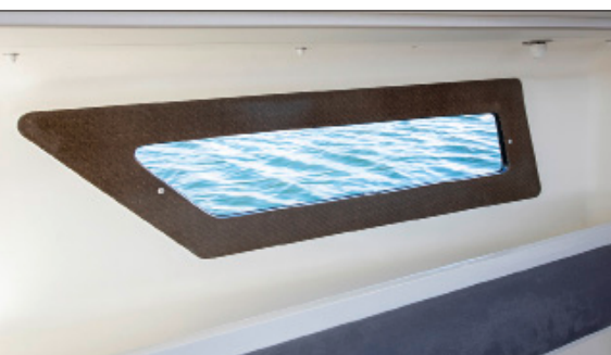
▲ Le chantier a rajouté des éléments de décoration où la fibre de lin est apparente.
