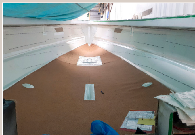
▲ Le feutre est remplacé par du liège et la mousse PVC qui constitue le sandwich par du plastique PET (matériau recyclable).
